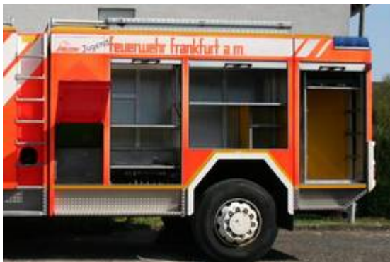
„Entkernte“, umgebaute Geräteräume
